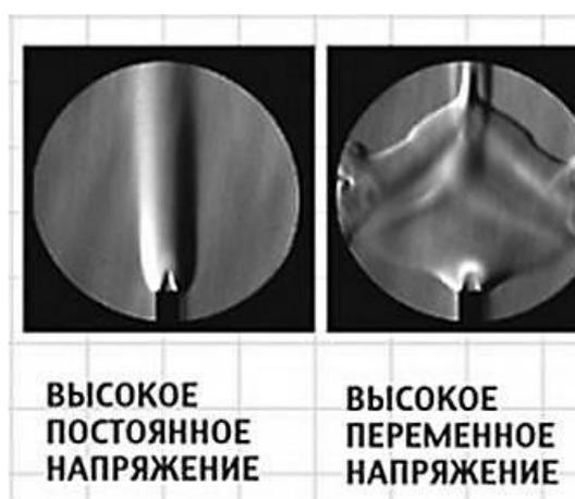
**Рисунок 2 – Изменение вида пламени под воздействием напряжения электродов**
