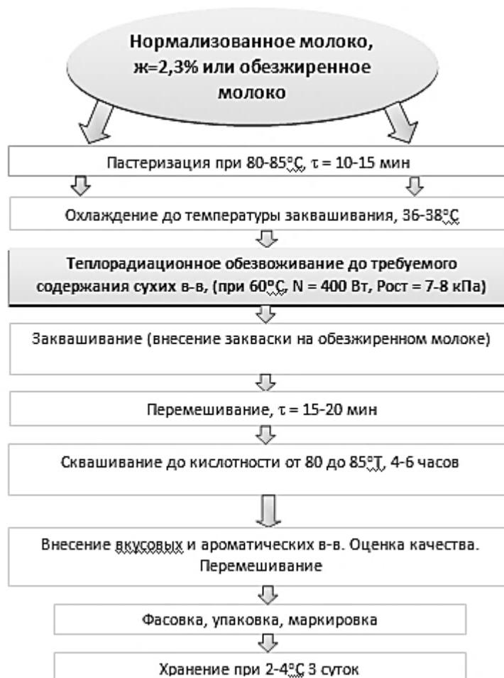
**Рисунок 1 – Технологическая схема производства молочно-белковой пасты методом теплорадиационного обезвоживания в условиях вакуума**
