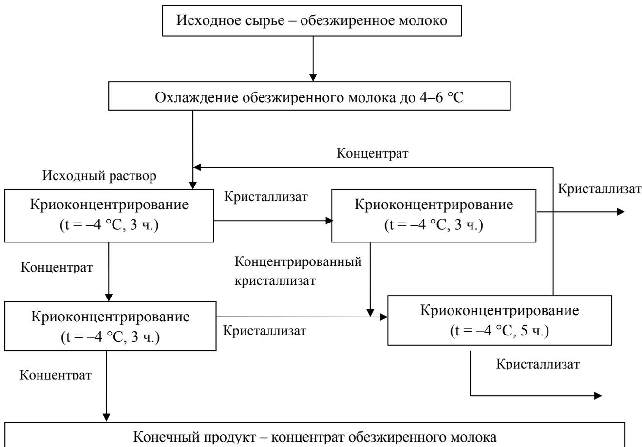
**Рисунок 3 – Блок-схема производства концентрированного обезжиренного молока**
