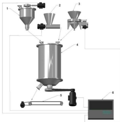
Рис. 2. Схема смесительного агрегата: 1, 2 и 3 – дозаторы; 4 – оригинальная конструкция центробежного СНД; 5 – ленточный пробоотборник; 6 – пульт управления
