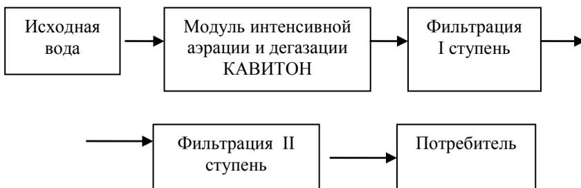
дегазации происходит в результате использования процессов дросселирования, кавитации, турбулентной диффузии, вакуумирования, что позволяет многократно увеличить скорость дегазации и аэрации в модуле по сравнению с традиционными способами. Удаление отработанных агрессивных газов (сероводород, углекислый газ) производится вытяжным вентилятором.
