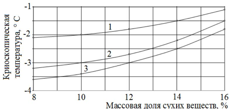
**Рис. 1.** Зависимости криоскопической температуры гидролизатов казеина от массовой доли сухих веществ: 1 – кислотный; 2 – щелочной; 3 – ферментативный
