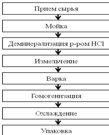
**Рис. 1.** Технологическая схема производства геля из *L. japonica*.
