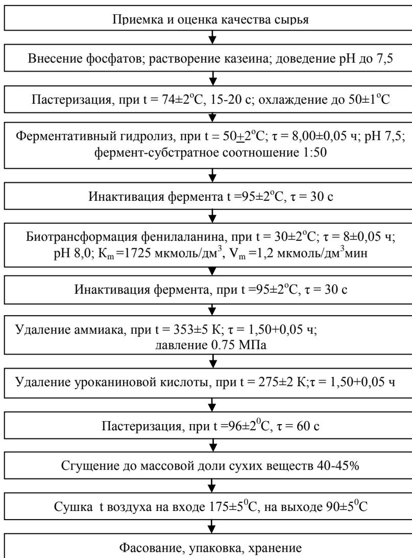
**Рис. 1.** Схема производства молочного белкового эквивалента для специализированных продуктов питания
